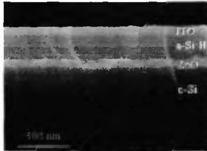
Figure 3.7: Photo SEM de la cellule test. Les épaisseurs respectives sont de 75 nm pour le ZnO, 220 nm pour l'a-Si:H et 65 nm pour l'ITO.
