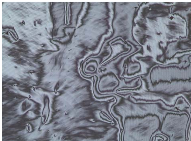
Figure 35 : texture Schlieren de la phase smectique C du monomère (±)-M1 à 165°C
