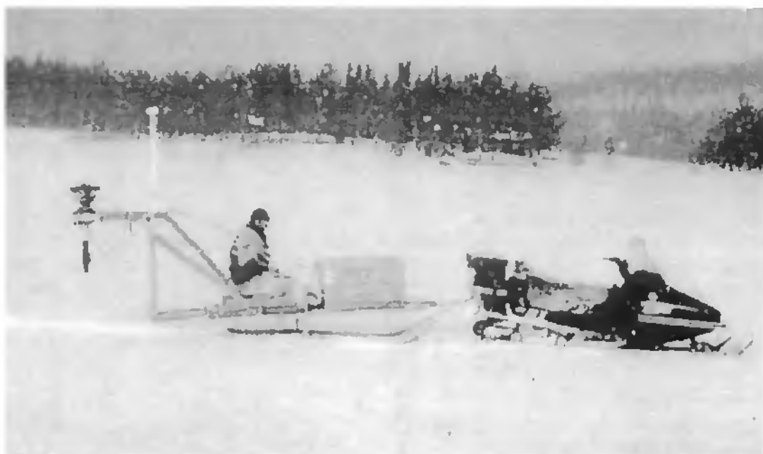
Abbildung 3.10: RF-EM mit Schneescooter (P. Turberg, Pers. Kommunik.)
