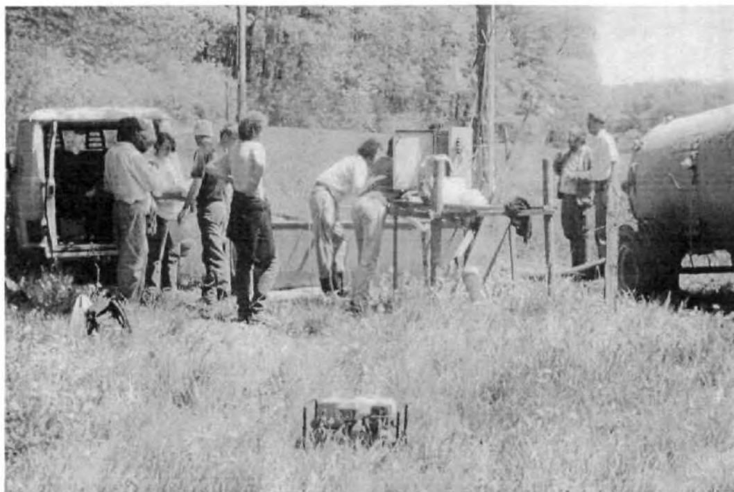
Abbildung 5.13: Tracerversuch in Bohrung Mil7 bei P4
