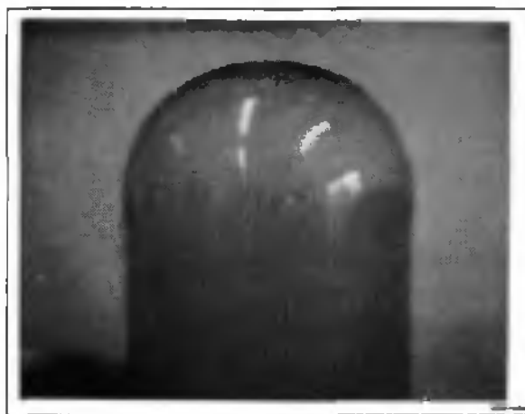
Figure 5.5 : Photo d'un ballon bien rodé téflonisé trois fois. On remarque de nombreuses coulures verticales
