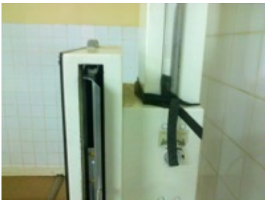
Image 29 : Tige de caoutchouc maintenant le porte détecteur et son axe. Crédits image : Nicolas Mabillard
