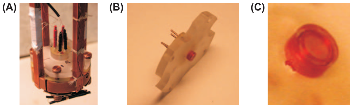
FIG. 2.6 – Micro-bobines pour les mesures inductives : (A) Assemblage avec le porte-échantillon, (B) Bobines encapsulées dans une matrice en styrcast, (C) Zoom sur le bobinage ( \phi 2.5 \text{ mm} )
