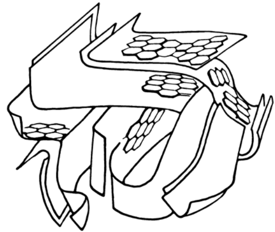
Figure 4 : Représentation de la microstructure d'un charbon actif [10]
