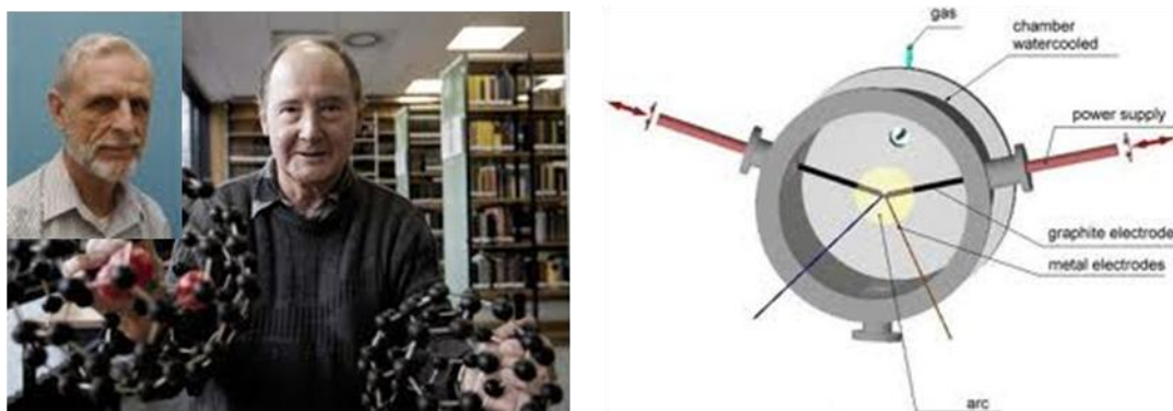
Figure 6.5 Photographies de Krätschmer et de Huffman (en médaillon) et schéma de leur réacteur pour la synthèse du C_{60} . Le principe est de vaporiser des atomes de carbone en bombardant une électrode de graphite à l'aide d'un arc électrique.
