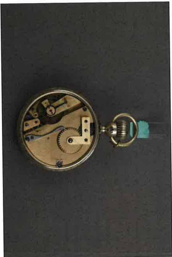
Abb. 5a: Roskopf-Bewegung mit Klinke aus einem Stück.
