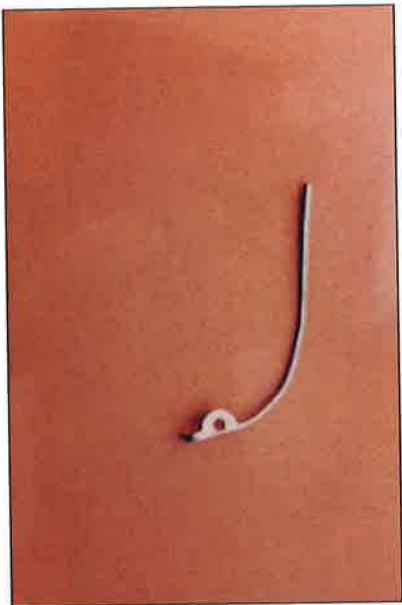
Abb. 3a: Originale Feder für den Hammer des Schlagwerks.
