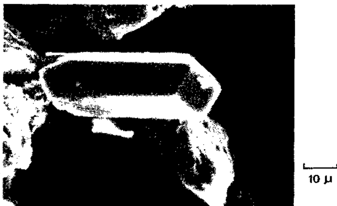
Figure 22 Tr : Une des rares albites authigènes observées dans le niveau type cornieule inférieure (R 704).
