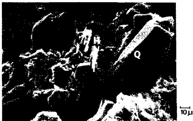
Figure 19 Tr : Photo au MEB illustrant le niveau type "cornieule". Les néoformations sont très importantes, l'hématite est au centre de la photo, le quartz constitue par exemple le prisme hexagonal dans la partie droite de la photo (R 704).
