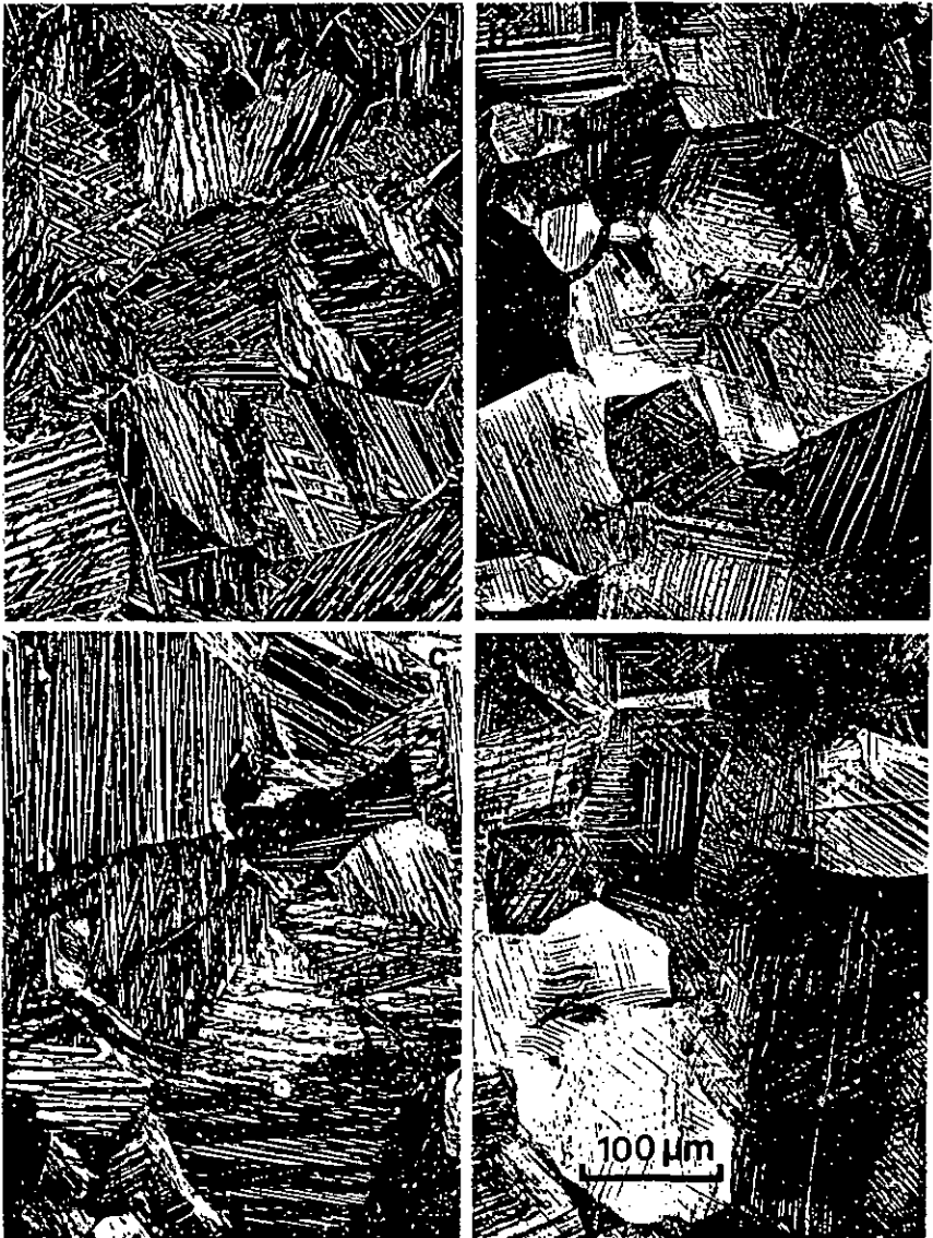
Figure III.32: Comparaisn de la microstructure des parties déformées et non-déformées des éprouvettes de traction préparées avec l'alliage: (a) M15 tête non-déformée, (b) M15 jauge déformée ( T_d=150^{\circ}\text{C} ), (c) M14 tête non-déformée, (d) M14 jauge déformée ( T_d=200^{\circ}\text{C} )
