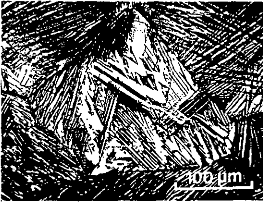
Figure III.36: Martensite induite thermiquement lors du refroidissement, après une charge-décharge à température T_d \geq A_f . Notons que les variantes de la martensite ne sont pas identiques avec celles du départ (figure III.35.a). La direction des variantes correspond en partie avec celles de la martensite induite par contrainte lors de la charge à T_d \geq A_f (figure III.34.b).
