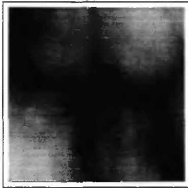
Figure 2.16 Image AFM de la surface d'un échantillon présentant une double structure. L'aire observée est de 1000x1000 nm, la rugosité de l'ordre de 350 Å.
