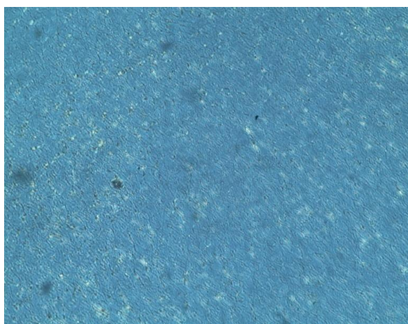
Figure 3.20 : Texture plane de Grandjean développée par le composé 20 à 91°C.
