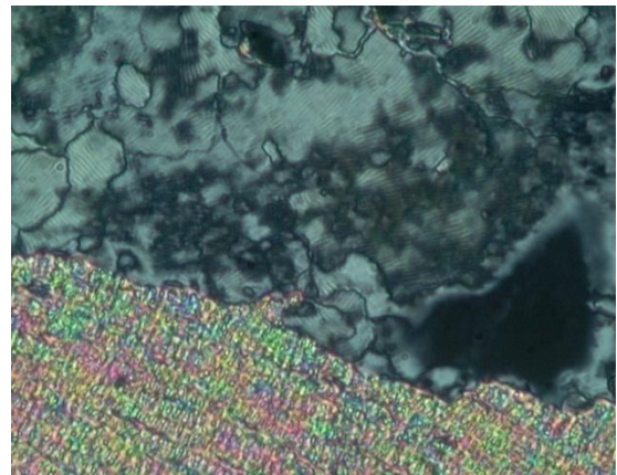
c) Texture de la phase SmC* développée par le composé 27 à 88°C
