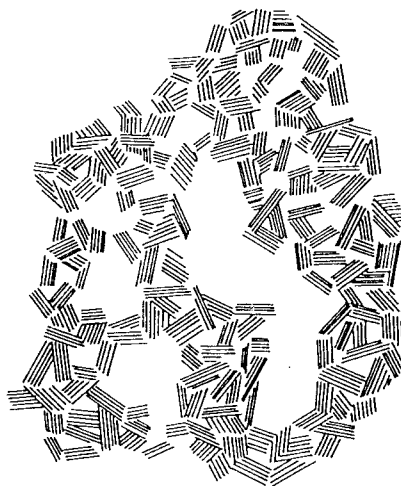
Fig. 2. Représentation schématique de l'aggrégation de microcristallites conduisant à la formation de pores de dimensions variables.
