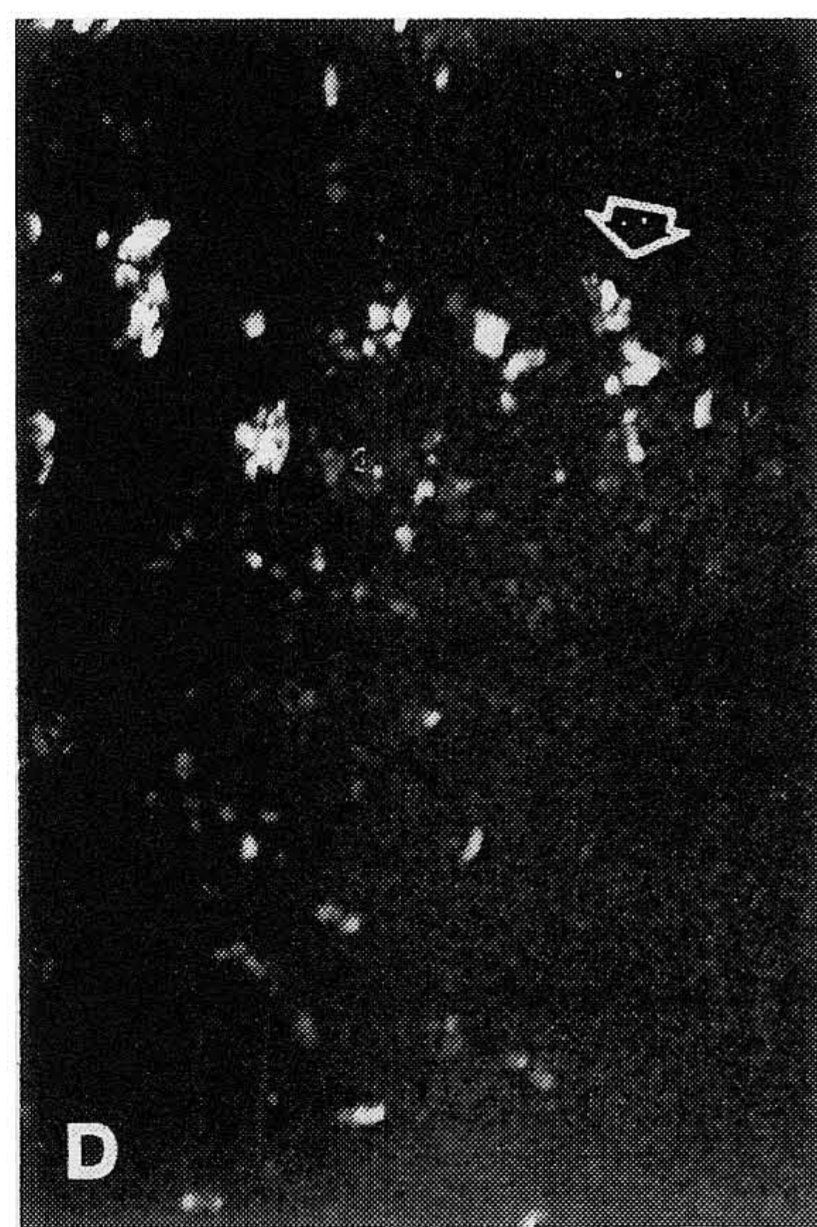
Micrographies des calcites artificielles avec un agrandissement final de 200.000 \times (Philips EM — 300). « STURGES 80 » en mode image (A) et en champ noir (B), et « CALOFORT-U » dans les mêmes conditions (C et D). Les taches blanches dans B et D correspondent à des microcristallites favorablement orientés. Les flèches indiquent les mêmes régions en champ clair et en champ noir.
