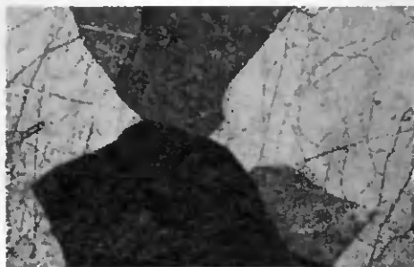
Fig. 2. Surface d'une plaque de \text{PbCl}_2 traitée par HCl 0,1M et composée de plusieurs cristaux d'orientations différentes
