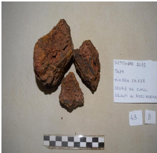
Fig. 1. Scoria prelevata nell'area della miniera di Taza Miniera Chikere, identificata come campione 43b.
