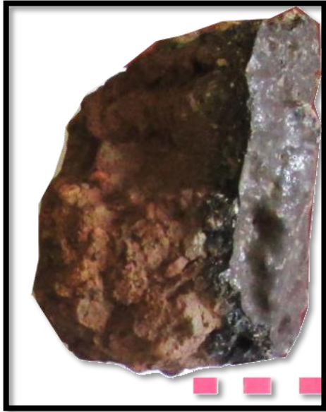
Fig.1 Frammento di parete di forno, denominato campione 22
