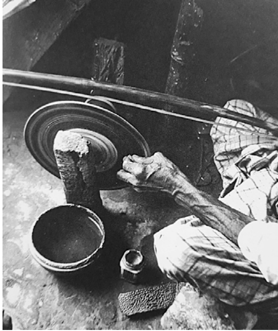
15. Hakkāk , ou tour lapidaire horizontal traditionnel indien, atelier de Bénarès (d'après MORERO E., JOHNS J., PROCOPIOU H., VARGIOLU R., ZAHOUANI H., « The Manufacturing Techniques of Fatimid Rock Crystal Ewers », in : HILGNER/GREIFF/QUAST 2017).
