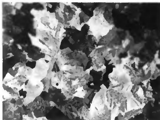
b) Ferrite après maintien isotherme à 600°C/1 min. Normalement la mémoire devrait être implantée.
