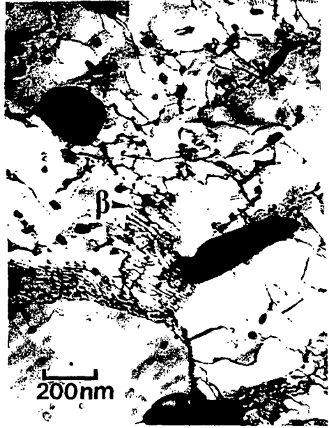
Fig. C.III.14. Sous-joint secondaire \beta d'un échantillon flué à 450°C sous 110 MPa jusqu'à 14 % de déformation.
