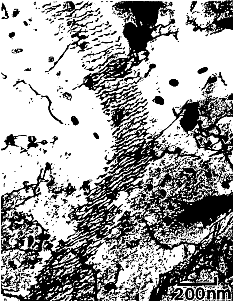
Fig. C.III.11. Sous-joint primaire \alpha observé dans un échantillon flué à 500°C sous 118 MPa.
