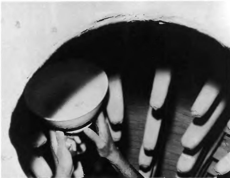
27. Supports à l'intérieur du four de type C.
