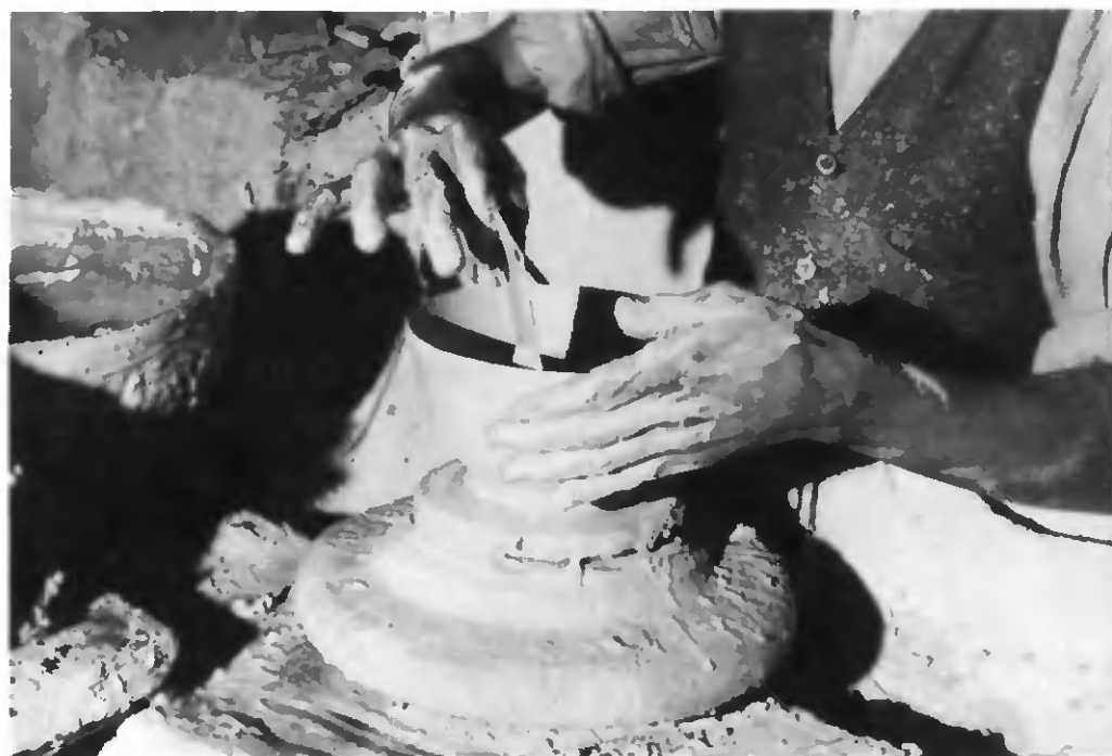
23. Tournage des bols en faïence; le diamètre en est donné au moyen de l'estèque de cuivre.
