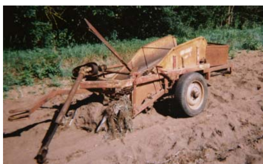
Fig. 37. Planteuse de pomme de terre bricolée par Serge, Lot (Clichés N. Viard 2001)
