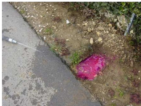
d) Injection de sulforhodamine B dans les fouilles IEC1 (détail)
