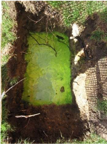
a) Injection de l'uranine dans la fouille IEN2
