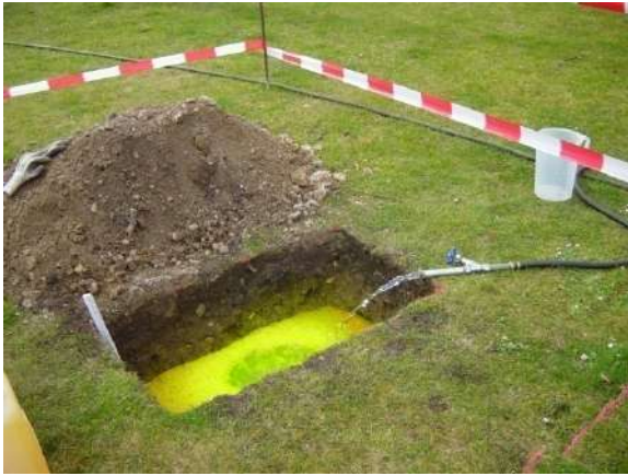
a) Injection de l'uranine dans la fouille IEN1
