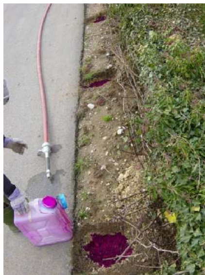
c) Injection de sulforhodamine B dans les fouilles IEC1 (6 fouilles au total)
