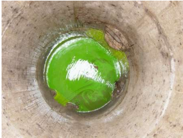
Fig. 3.5 : Exfiltration de l'uranine dans le collecteur ICC pendant l'essai du printemps 2007 (la photo a été prise environ 1h après l'injection du traceur dans la fouille IEC2)
