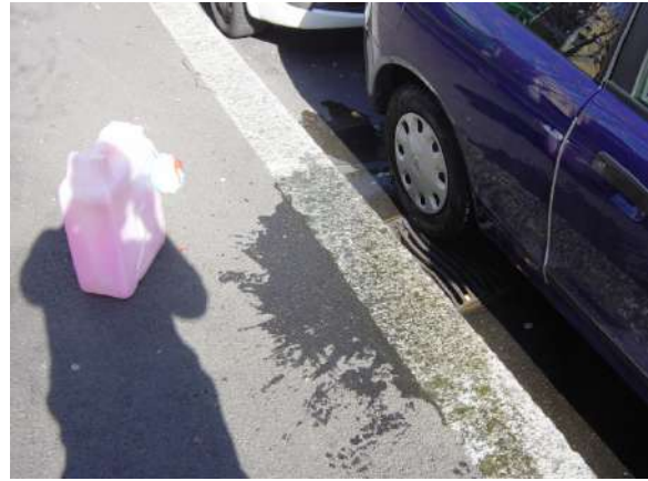
c) Injection de la sulforhodamine B dans le caniveau ICN
