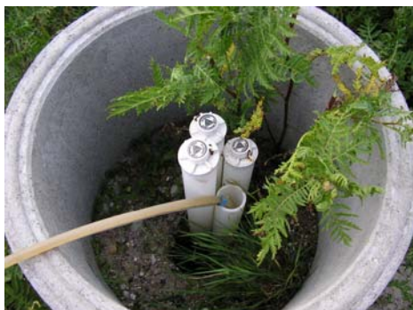
Figure 4.1 : "Multilevel wells" sur le site d'étude de Rødekro (forage B61). Le piézomètre le plus bas est celui ayant une crépine à la plus grande profondeur et le plus haut celui ayant une crépine à la moins grande profondeur.
