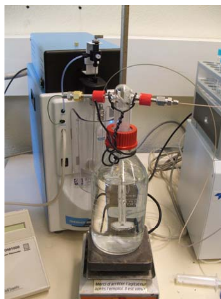
Figure 4.5 : le système GM-Combustion/IRMS (gauche) et le dispositif mis en place pour l'analyse d'échantillon de 1 litre (droite).
