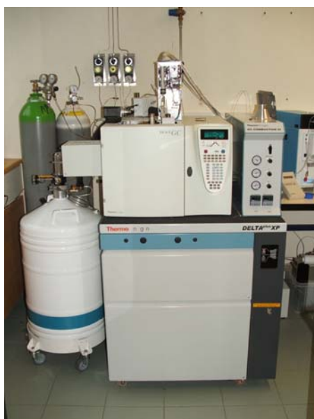
Figure 4.5 : le système GM-Combustion/IRMS (gauche) et le dispositif mis en place pour l'analyse d'échantillon de 1 litre (droite).
