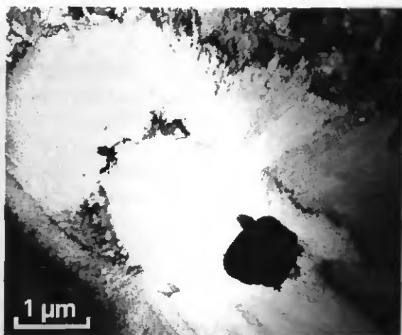
Figure 4.19a: Alliage A ( \text{Fe}_{71}\text{Cr}_{18}\text{Mo}_6\text{B}_5 ) solidifié par "melt-spinning". V_{\text{roue}} = 26 \text{ ms}^{-1} ; épaisseur du ruban = 35 \mu\text{m} . Microstructure de côté roue; MET.
