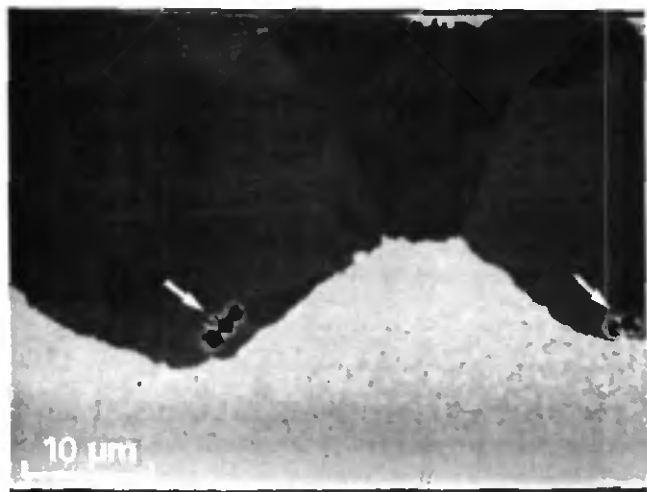
Figure 4.18: Alliage A ( \text{Fe}_{71}\text{Cr}_{18}\text{Mo}_6\text{B}_5 ) solidifié par "melt-spinning". V_{\text{roue}} = 26 \text{ ms}^{-1} ; épaisseur du ruban \approx 35 \text{ }\mu\text{m} . MEB (contraste cristallographique).
