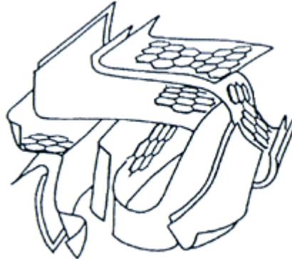
Figure 1 : Modèle schématique de la structure d'un charbon actif.
