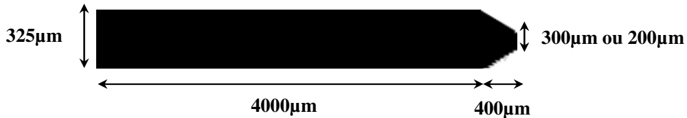
Figure A- 9 : Diagramme schématique du canal principal aux entrées et sorties des dispositifs IMT 1.
