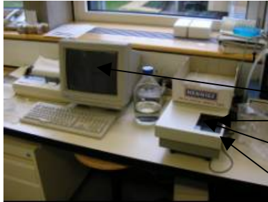
Photo 5.2 : Système laser relié à un ordinateur de type GALAI CIS-1 pour l'analyse de la fraction < 63 µm.
