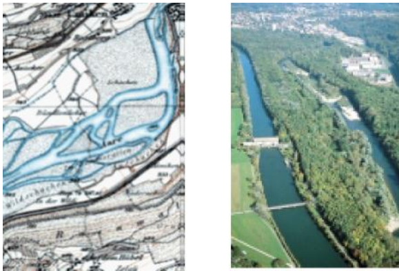
Figure 2: Zone alluviale d'Umiker Schachen avant (à gauche) et après endiguement (à droite). Les travaux d'endiguement se sont déroulés entre 1949 et 1953.
