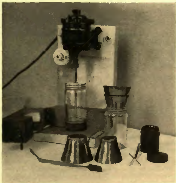
Fig. 1. Appareillage utilisé. On voit: l'agitateur avec le moteur à axe vertical, au premier plan, la spatule métallique et les deux tamis de cuivre, à droite, un agitateur montrant la disposition des bras horizontaux; le récipient dans lequel est expédié l'échantillon et au centre arrière les deux tamis emboîtés l'un dans l'autre tels qu'ils sont disposés pour le tamisage.
