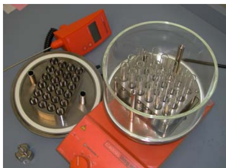
Figure II. 1.10 : Multi-réacteur 24 puits avec un système de reflux et une entrée d'azote (Radley's)
