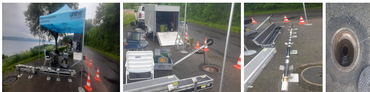
Figure 70: Quatre vues illustrant l'acquisition des données soniques sur les trois forages RSBV1 , RSBV2 et RSBV3 .
