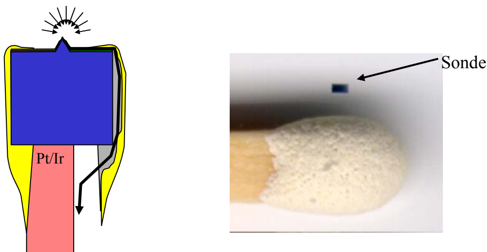
Figure 2.2-2 : Schéma de la connexion et de l'encapsulation de l'électrode avec comme témoin une tête d'allumette à côté de la sonde.
