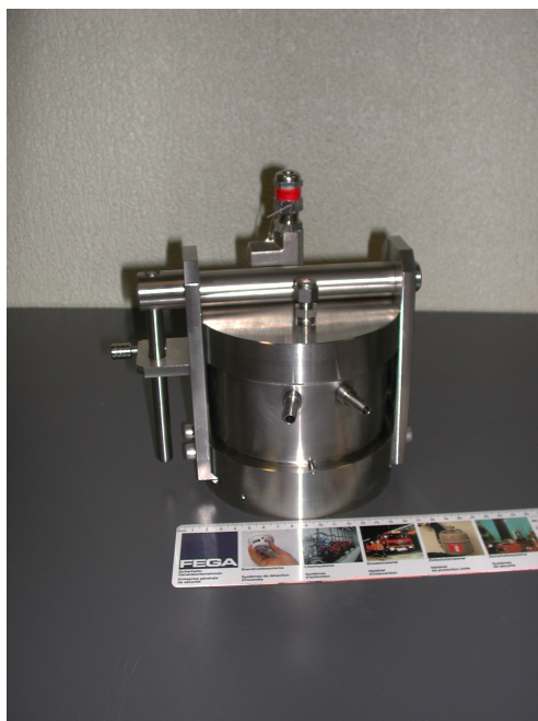
Figure II 2.3. Multi-réacteur 20 puits avec un système de reflux et une entrée de gaz inerte (azote ou argon).
