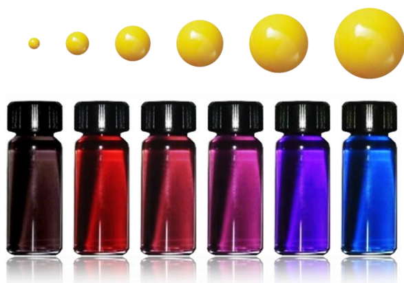
Figure 3.8 Exemples de différentes couleurs que peuvent présenter les nanoparticules d'or en fonction de l'augmentation de leurs diamètres.
