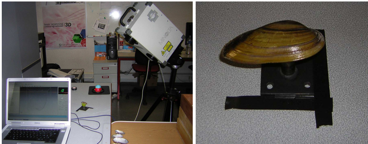
FIG. 6.5 – Dispositif de numérisation de la surface d'une coquille posée sur un support à l'aide du scanner VI-910 de Konica-Minolta. Coquille posée sur son support.
