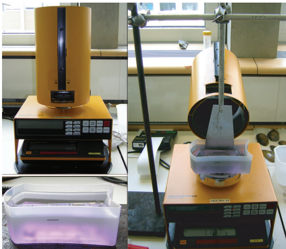
FIG. B.1 – Balance utilisée pour la mesure des volumes, récipient utilisé pour la mesure des volumes et procédure de mesure des volumes.
