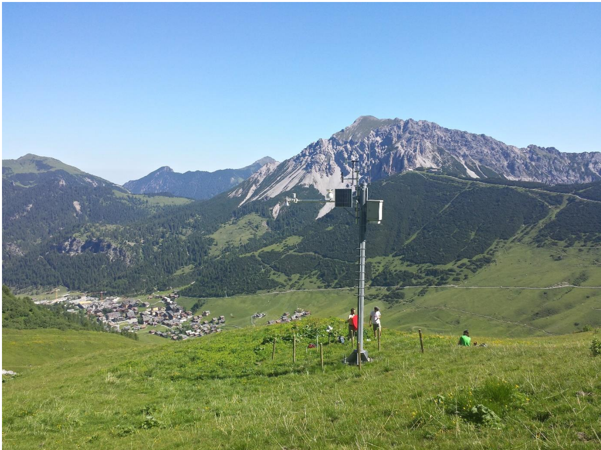
Figure 7 Exemple de l'installation d'une station IMIS mesurant l'épaisseur de neige au sol. Cas de la station « MLB2 », située au Liechtenstein à 1976 m d'altitude, non loin du village de Malbun.
