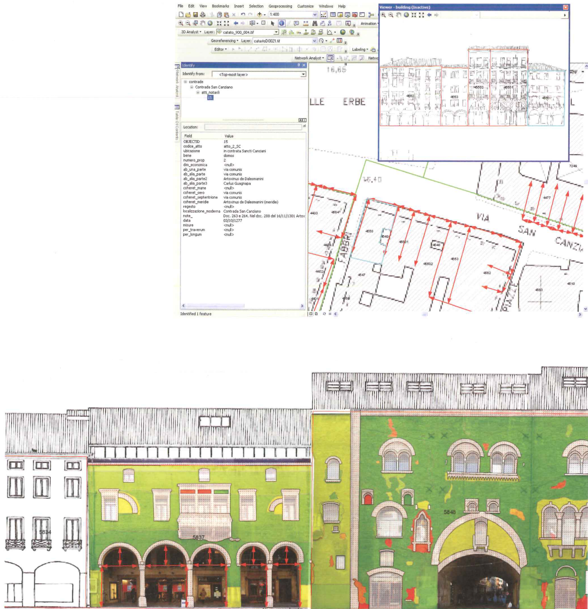
FIGURE 6.4 – Padoue. Gestion des analyses chronologiques dans le SIG et différenciation des éléments du bâti par des points géoréférenciés (Chavarria Arnau, 2011, p. 174)
