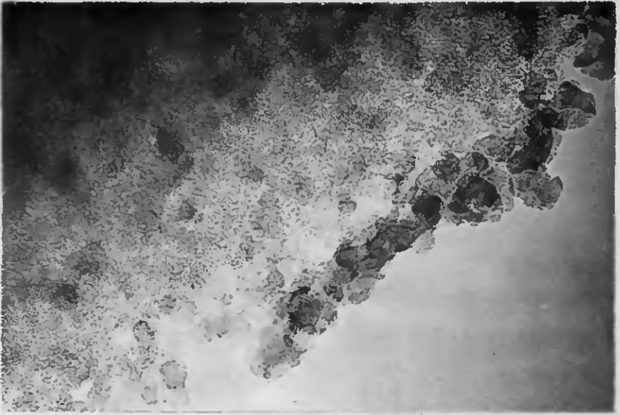
Fig. 3.3. Micrographie en champ clair du charbon T \llcorner 100 Å
