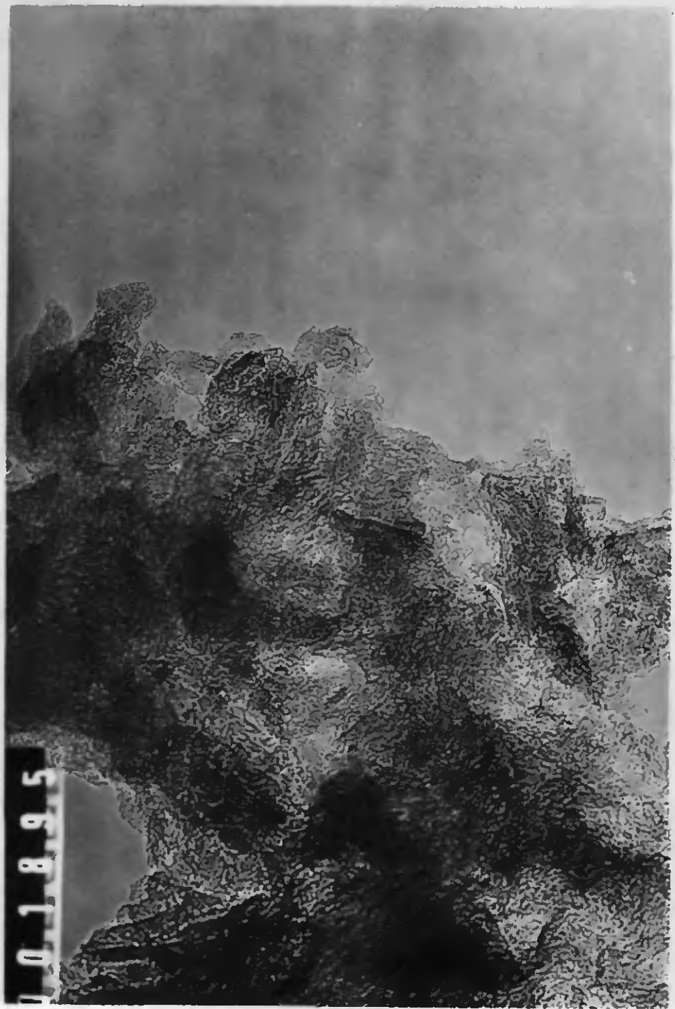
Fig. 3.5. Micrographie du charbon U02 (vue générale) \text{L} \text{---} \text{L} \text{---} \text{L} 100 Å
