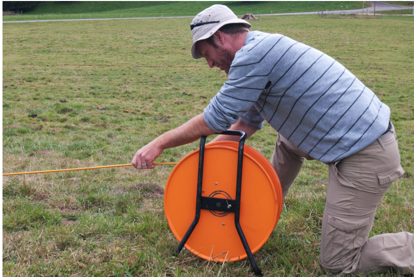
(a) Un câble pour les ERT.
