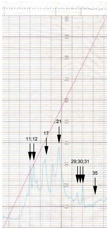
Fig 35 : Chromatogramme obtenu par mesure de l'absorbance à \lambda=280 nm de l'éluat pendant la FPLC.
