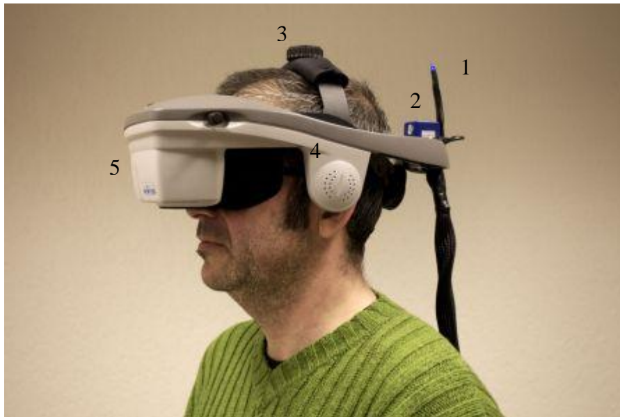
Abbildung 6. Head Mountend Displays (HMD) mit 1 LED-Marker, 2 Inertia-Cube, 3 Fixierungen, 4 Kopfhörer, 5 Displays
