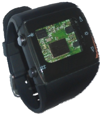
Fig. 7: prototype de montre pour la détection des chutes
