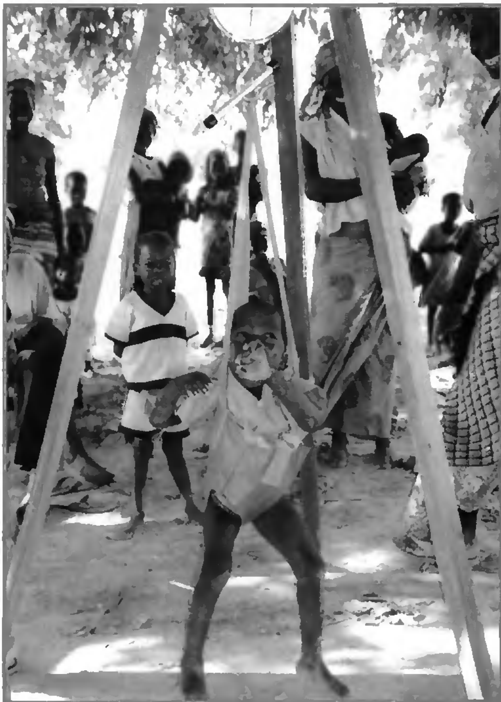
Planche XVIII: Mesure du poids à l'aide d'une balance à ressort accrochée à un trépied transportable
