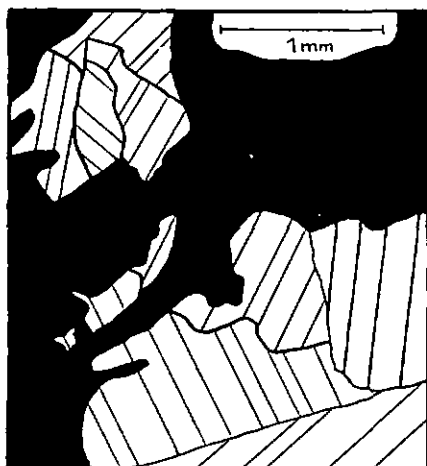
Fig. 9. Dolomiteinschlüsse (weiss) in Serpentin (schwarz). Die Schraffur entspricht der Parallelstreifung des Dolomites.
