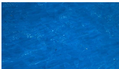
Figure 4.10. Texture de la phase nématique chirale à 102 °C présentée par l'oléfine 21
