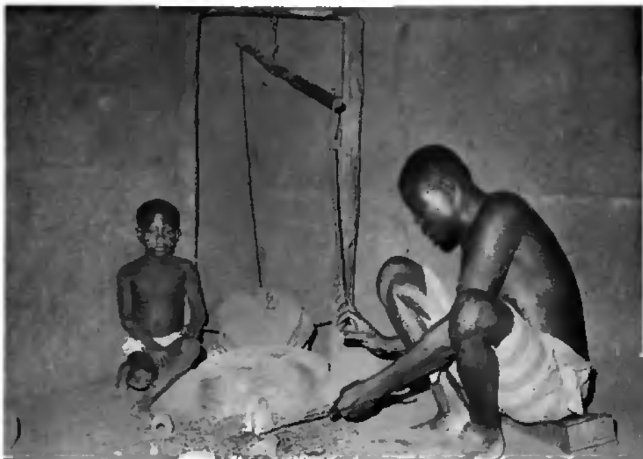
Fig. 5 Forgeron-bijoutier soudant un bracelet (Abomey, 1973).
