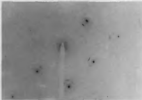
Bild 3b. Beugungsdiagramm zu Bild 3a, Bildrotation korrigiert.
