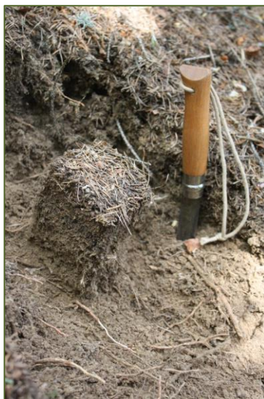
Figure 15. Petite colonne de sol (surface 5 x 5 cm) préparée sur le site S08 pour la méthode des petits volumes, avant l'échantillonnage des différentes couches. D. Tatti, le 15 août 2013.
