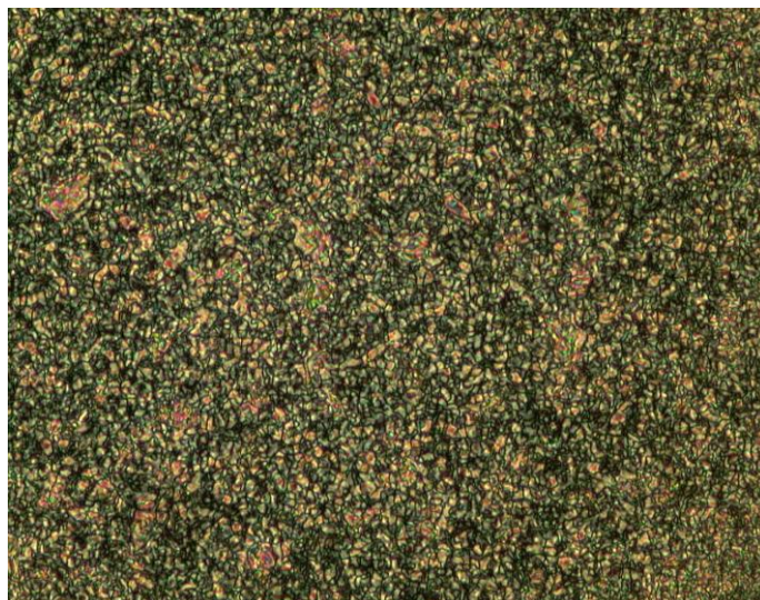
Figure 70 : texture de la phase SmC* (shlieren) à 96 °C (zoom 200x) présentée par le composé 70
