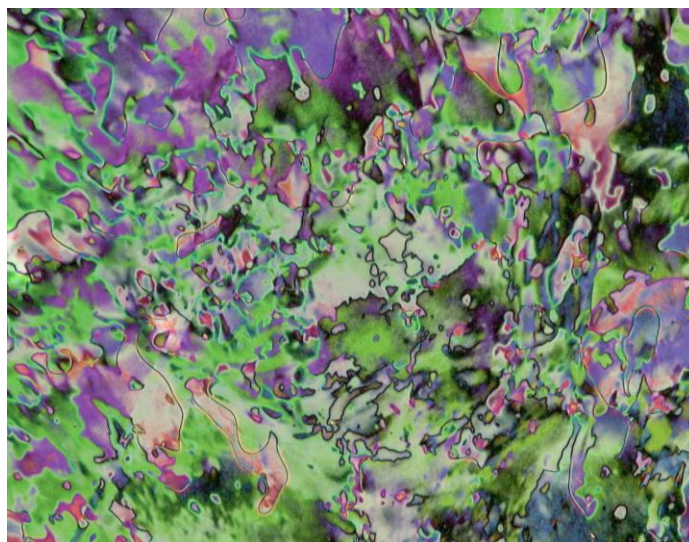
Figure 46 : texture de la phase N (schlieren) à 158 °C (zoom 100x) présentée par le composé 47
