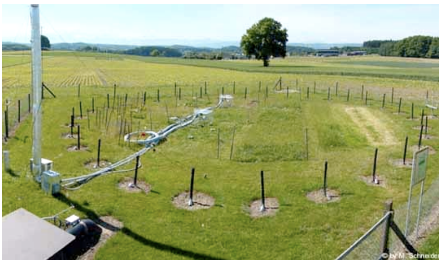
Figure 1.4.E Chaque parcelle enrichie en CO 2 est constituée d'un cercle de 18 m de diamètre. Une mini-station météo contrôle la teneur en CO 2 (en bas à gauche) et des tuyaux répartis autour permettent d'insuffler de l'air enrichi en fonction de la direction et de la vitesse du vent. Le système fonctionne durant la journée pendant toute la saison de végétation
